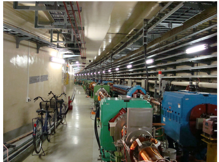
Slika 2: Pospeševalniški kompleks SuperKEKB, zaporedje linearnega pospeševalnika, pozitronskega zbiralnika, glavnega obroča in detektorja Belle II ob točki, kjer trkajo elektroni in pozitroni (levo); desno: 3km dolg tunel pospeševalnika.
